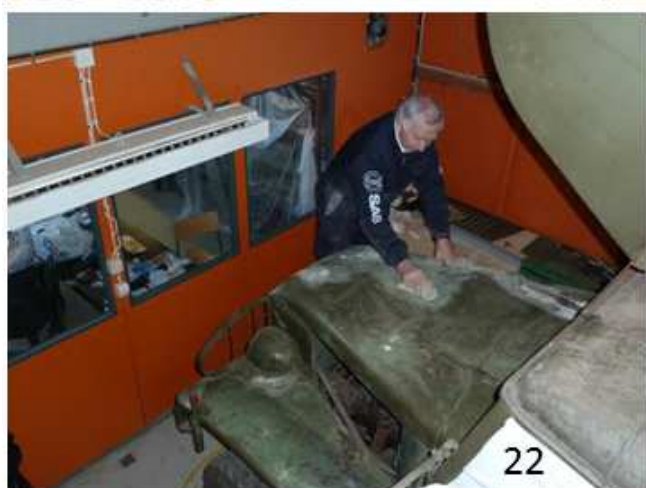
19 2011-02-16 Rostputs, spackling och grundmålning av Indikatorvagnen 20 2011-02-16 Rostputs, spackling och grundmålning av Indikatorvagnen 21 2011-02-22 Rostputs, spackling och grundmålning av Indikatorvagnen 22 2011-02-22 Rostputs, spackling och grundmålning av Indikatorvagnen 23 2011-02-22 Rostputs, spackling och grundmålning av Indikatorvagnen
