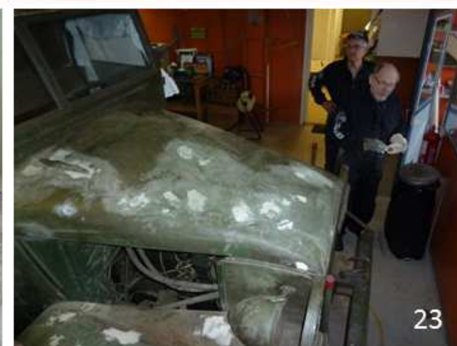
19 2011-02-16 Rostputs, spackling och grundmålning av Indikatorvagnen 20 2011-02-16 Rostputs, spackling och grundmålning av Indikatorvagnen 21 2011-02-22 Rostputs, spackling och grundmålning av Indikatorvagnen 22 2011-02-22 Rostputs, spackling och grundmålning av Indikatorvagnen 23 2011-02-22 Rostputs, spackling och grundmålning av Indikatorvagnen
